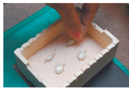
パーツを乾燥させたら、焼成ボックスに入れて電気炉で焼成する。
