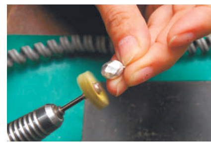
パーツを電気炉へ入れて約10分。炉から出して冷まし、電動研磨機で磨き始めると、乳白色から銀色へと変化する。
